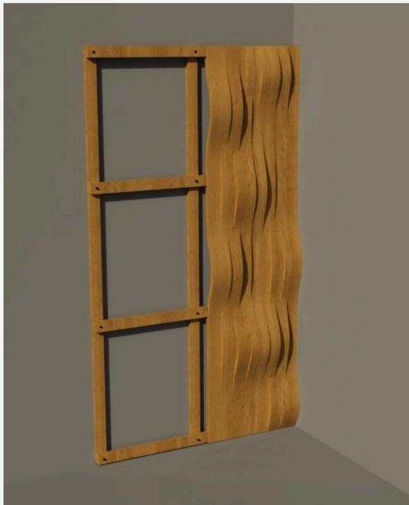
El detalle constructivo de la pared falsa consiste en una estructura de madera con tiras horizontales cada 60 cm y verticales cada 60 cm, anclada a la pared existente con tornillos y tacos Fischer. Sobre esta estructura se fijan tiras onduladas mediante tarugos de madera, asegurando una sujeción sólida y una superficie estética. Este método garantiza una instalación duradera y visualmente atractiva, destacando por su precisión y calidad en la ejecución.
