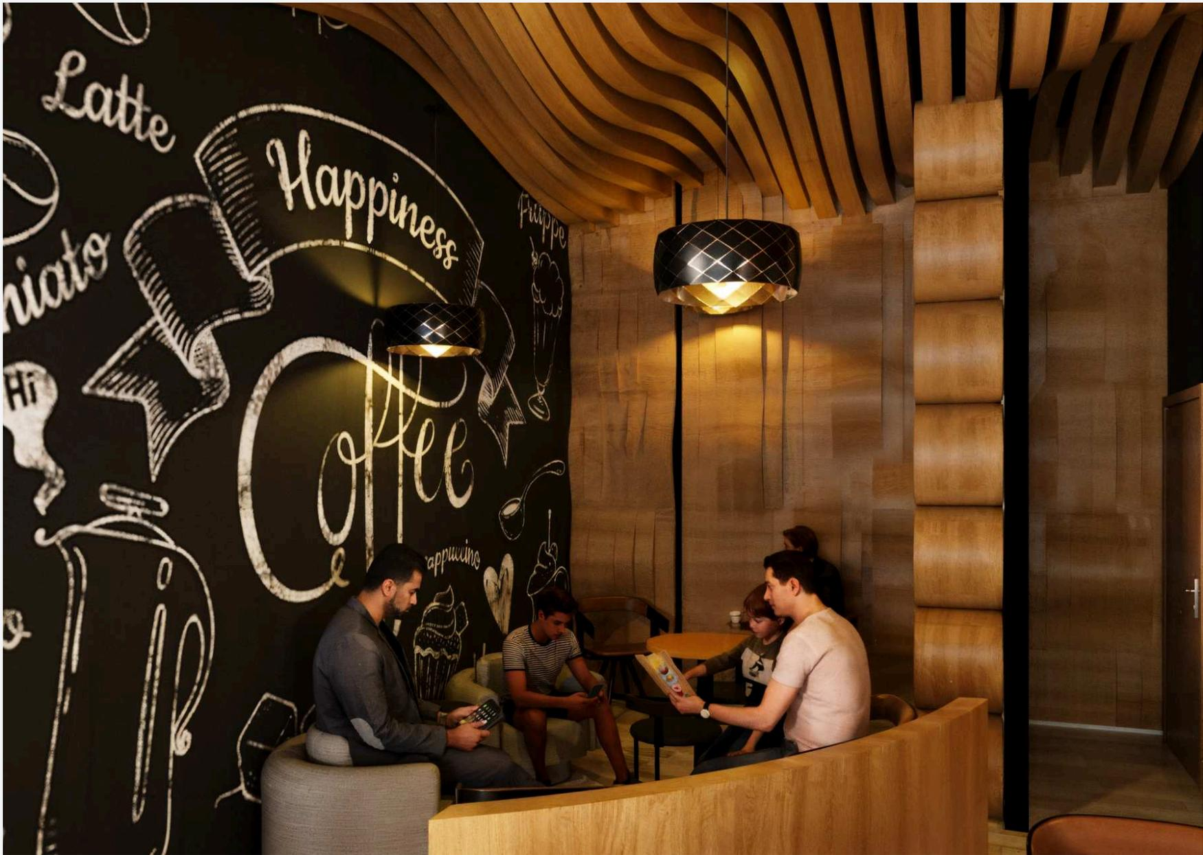
1. Las formas curvas se construirán utilizando madera sólida y estarán ancladas al cielo raso mediante cáncamos para garantizar su estabilidad y resistencia.
