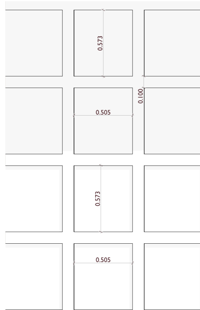
Elevación Ventanas C. de Bomberos ESC: 1:200
