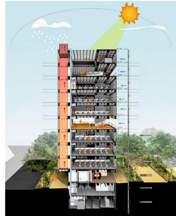
Fig 16. Sección / Torre de ventilación. Fuente: X.
