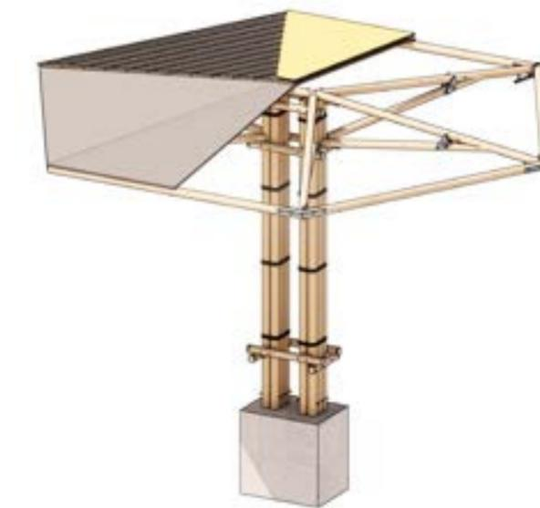
Módulo estructural de cubierta convexa, pendiente del 7%
