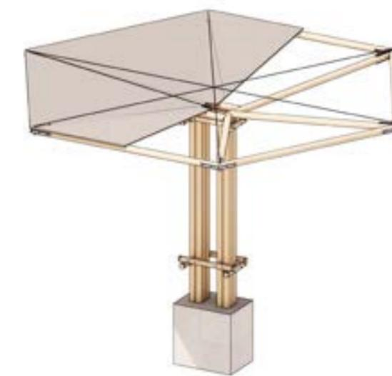
Módulo estructural de cubierta cóncava, pendiente del 7% para recolectar agua lluvia
