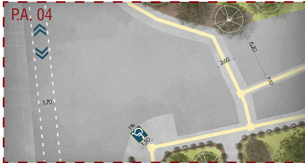
Figura 135. Implementación de un sistema podotáctil dentro del campus para la movilidad universal y modificación de porcentaje de inclinación de las rampas existentes. Fuente: Autoría propia.
