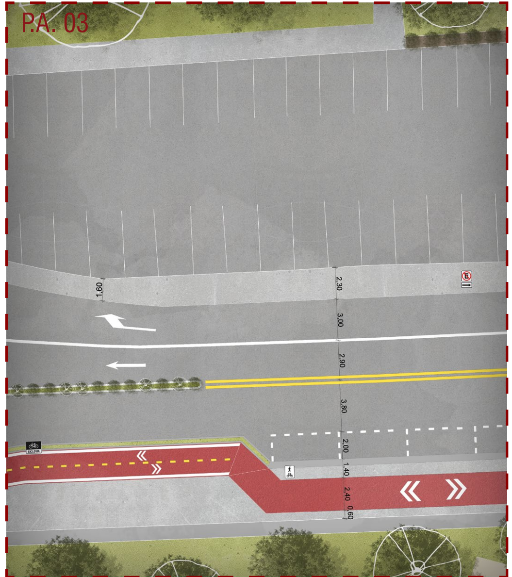
Figura 112. Bahía de estacionamiento temporal, entrada principal.
