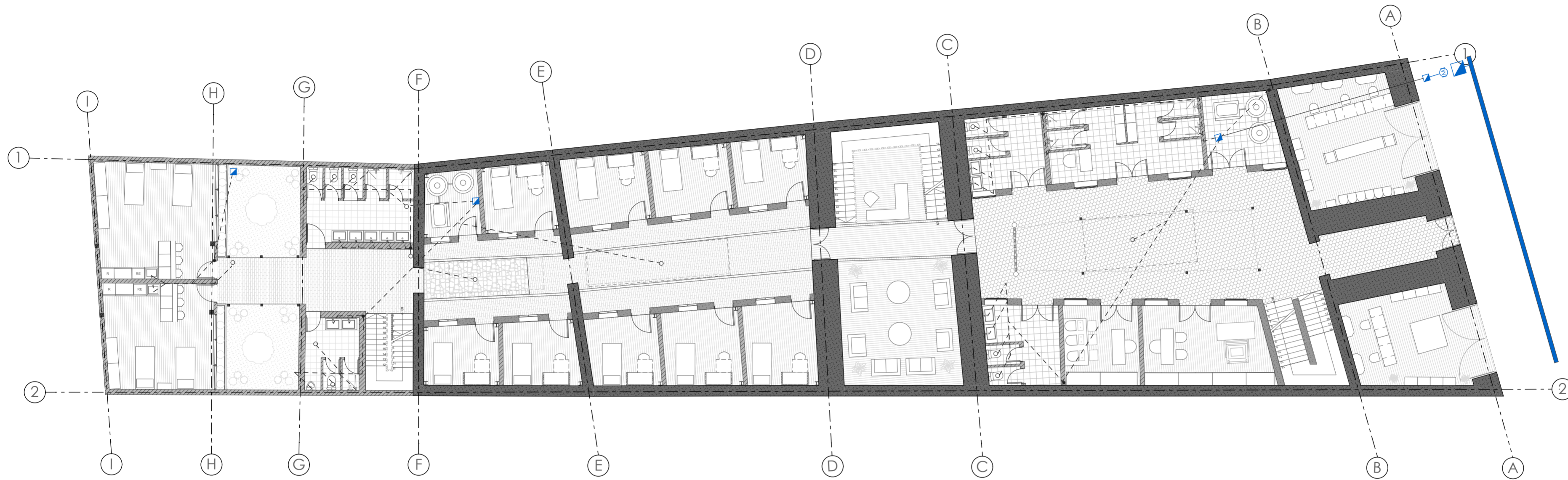
PLANTA BAJA DE INSTALACIONES HIDROSANITARIAS ESCALA: 1:150
