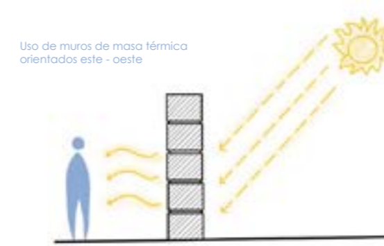
Fig 64. Muros de masa térmica.
