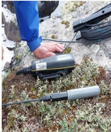
Imagen 5: Medición de parámetros físicos, pH, conductividad, oxígeno disuelto, temperatura.
