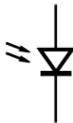
Figura 20: Símbolo del fotodiodo
