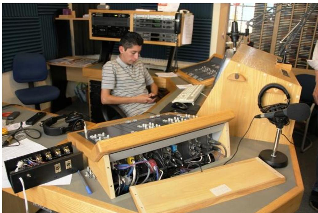
Fotografía 2: Parte posterior de la consola de audio y junto a ella nuestro autoswitch antes de la instalación.
