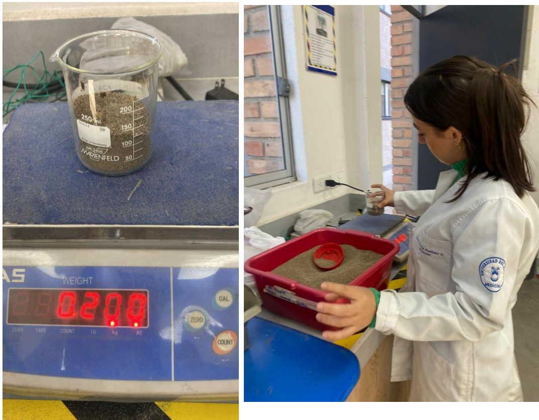
Figura 6. Pesaje de material (arena) para filtros de agua
