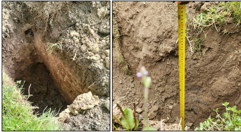
Figura 5-2: Calicatas 1 y 3 a 1.50 metros de profundidad
