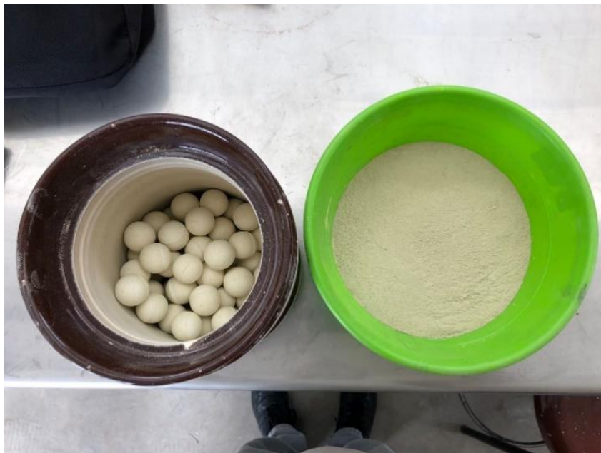
Figura 3. Zeolita y carga de bolas de sílice para molienda
