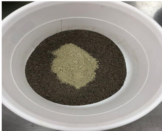
Figura 8. Dosificación de zeolita en la elaboración de morteros
