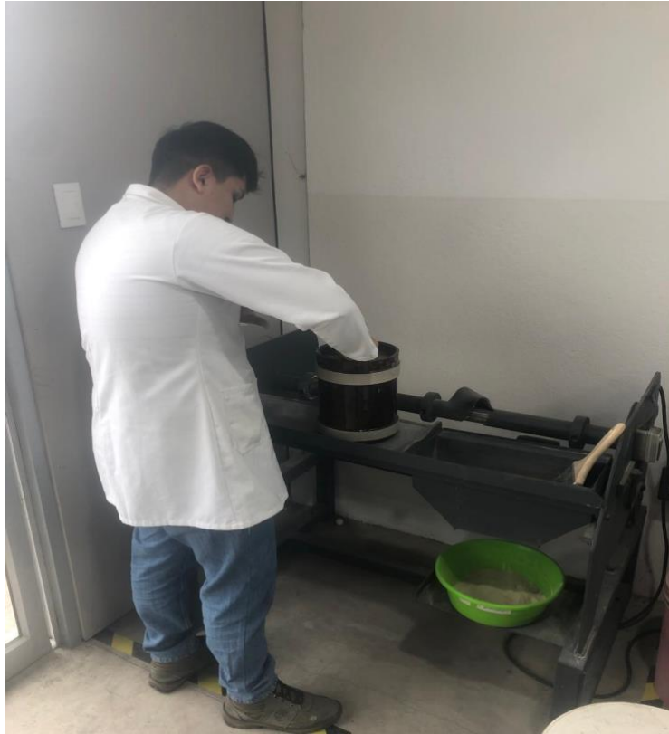
Anexo 4. Molienda de zeolita en el laboratorio de ingeniería en Minas de las Universidad del Azuay.
