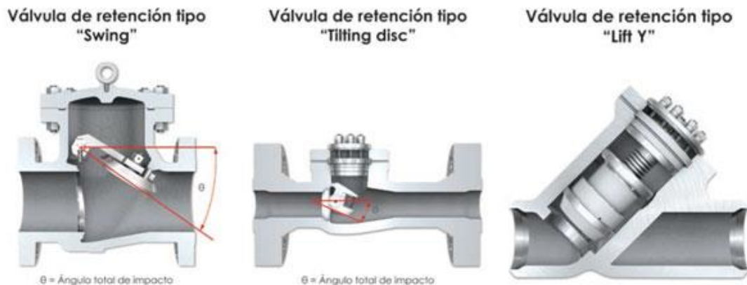
Figura 2.4 Tipos de válvulas de check
