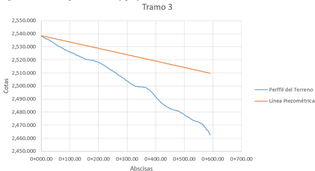
Figura 3.10 Línea piezométrica y perfil del tramo 3
