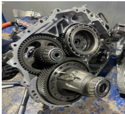
Figura 7. Desmontaje de carcasa
