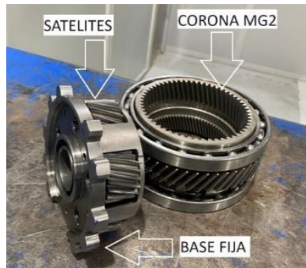
Figura 4 Conjunto de engranes de MG2
