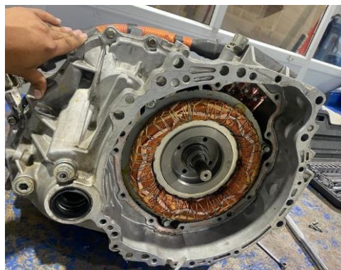
Figura 5. Desmontaje de tapa
