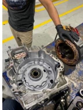
Figura 8. Desmontaje de motores eléctricos
