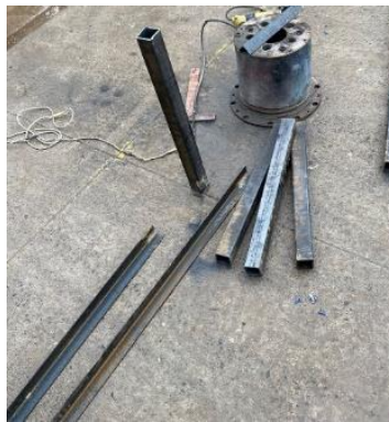
Figura 10. Cortes de tubos y ángulos
