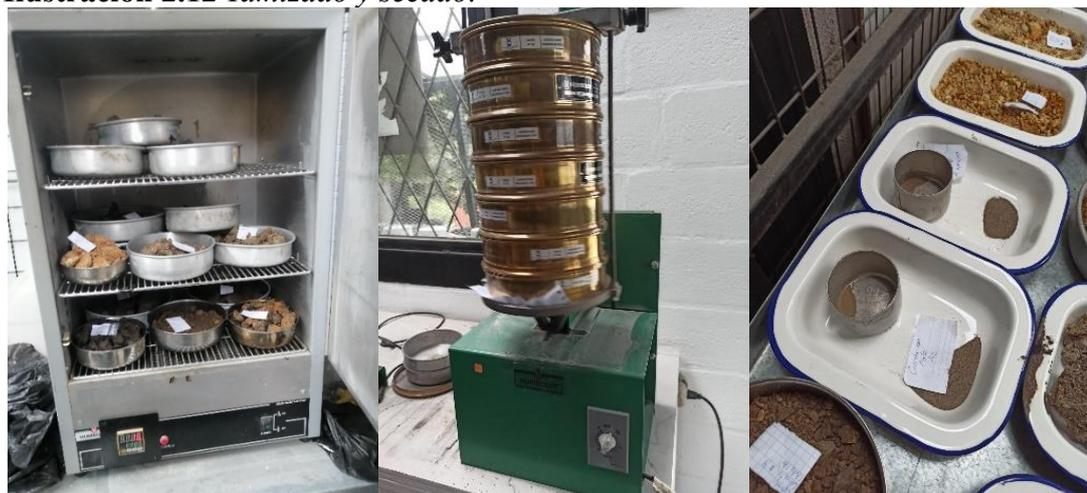
*Nota:* Para la imagen izquierda se evidencia el proceso de secado de las muestras en el horno, la intermedia ilustra el tamizado mecánico, con los tamices descritos; por último, la imagen derecha muestra el restante de finos en el suelo, para ensayos posteriores.
