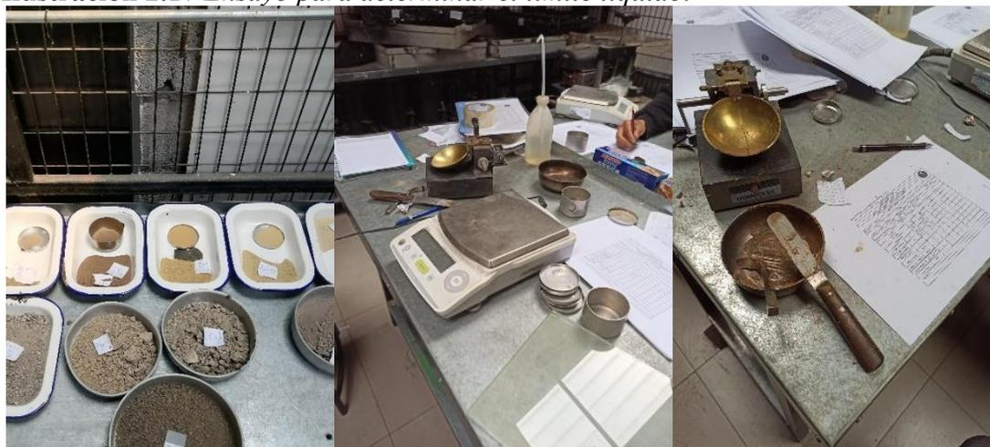
*Nota:* La imagen de la izquierda la separación de las muestras por estrado y apertura de tamiz, la imagen central, por otro lado, muestra el equipo utilizado para los ensayos; por último, la imagen derecha nos muestra el aparato de Casa Grande, y la muestra preparada para el ensayo.
