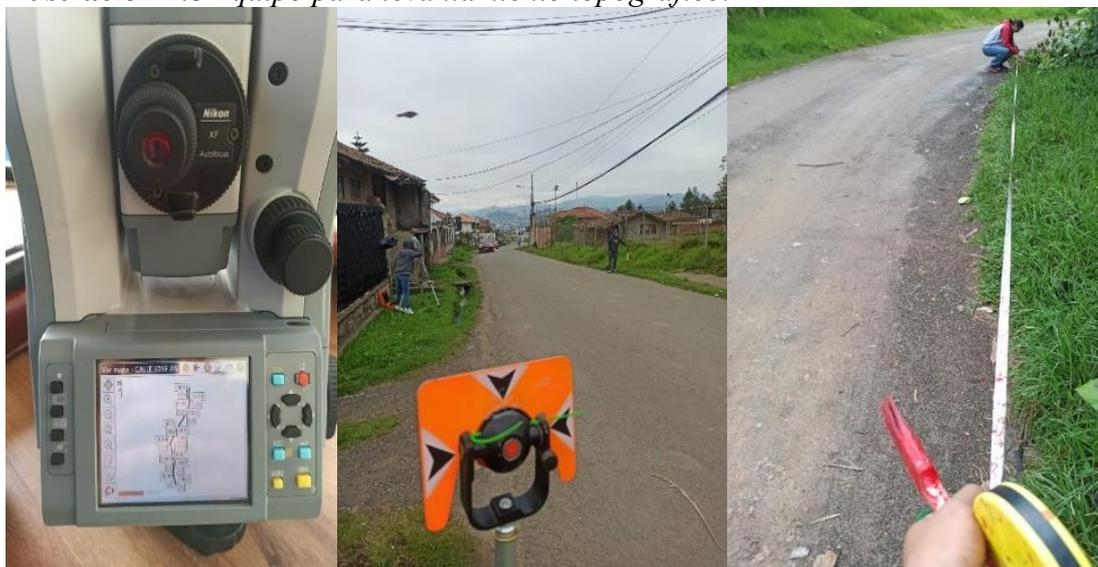
*Nota:* En la imagen izquierda se adjunta el equipo utilizado en el levantamiento, por otro lado, la imagen central busca presentar una vista de la vía y el prisma para la toma de puntos, finalmente la imagen izquierda evidencia la medición (cinta) y marcas de la vía para el levantamiento.
