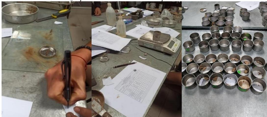
Nota: En la figura izquierda se muestra el ensayo de límite plástico ensayado, de manera similar la imagen central corresponde al pesado de la muestra húmeda en la balanza, por último, se muestran las muestras resultantes después del secado para ser pesadas en la balanza.
