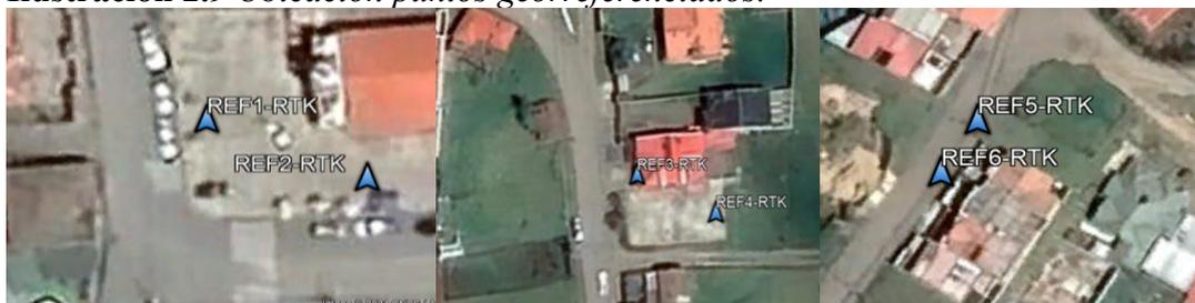
*Nota:* En la ilustración izquierda se muestra la vista en planta de los dos primeros pares de clavos referenciados (Iglesia), en la imagen central los siguientes pares de clavos (Cancha), y finalmente en la imagen izquierda los dos últimos pares de clavos (Intersección).
