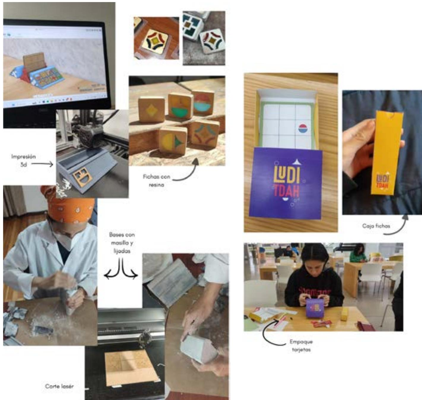
Tras completar el modelado, se enviaron las bases de las fichas a imprimir en 3D utilizando filamento PLA gris.
