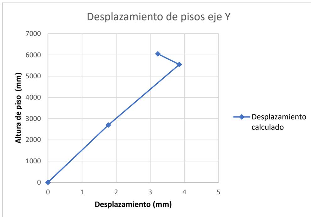
Figura 3-24 Desplazamientos obtenidos en dirección Y. Fuente: (Autor, 2024)
