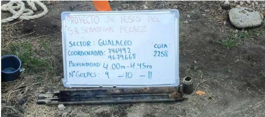
Figura 2-3 Toma 3, ensayo SPT. Fuente: (INGEO, 2024)
