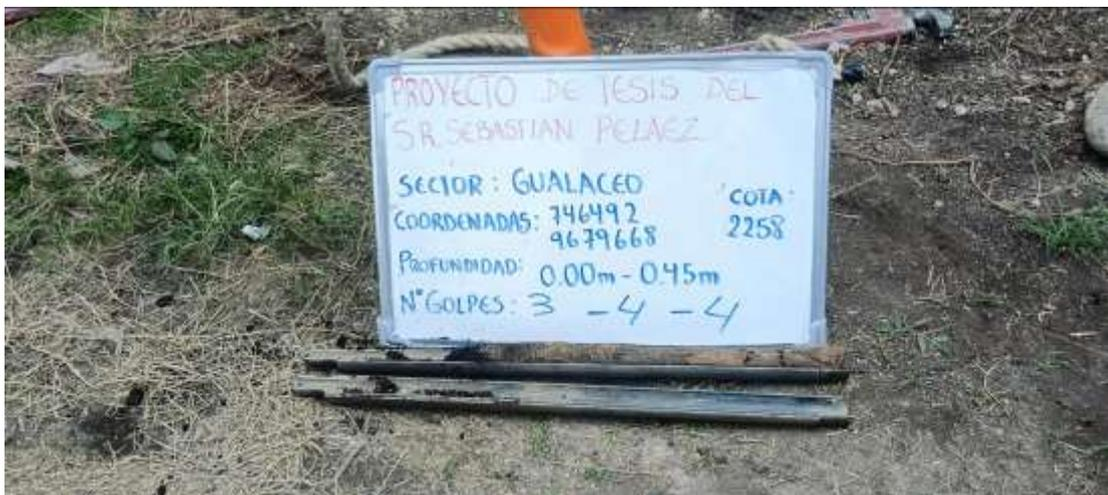
Figura 2-2 Toma 2, ensayo SPT. Fuente: (INGEO, 2024)
