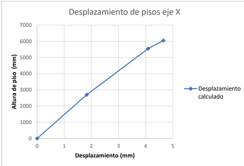
Figura 3-23 Desplazamientos obtenidos en dirección X. Fuente: (Autor, 2024)
