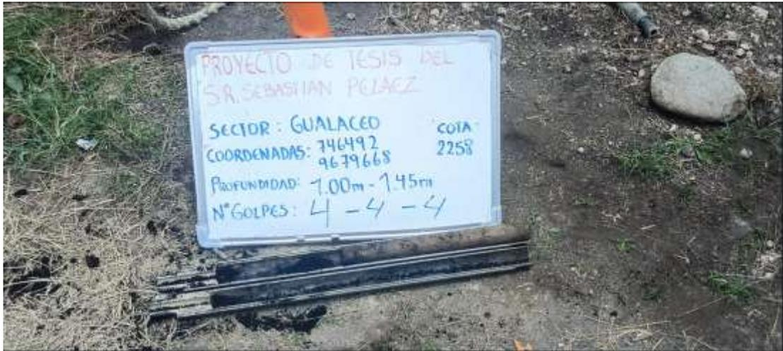
Figura 2-1 Toma 1, ensayo SPT. Fuente: (INGEO, 2024)
