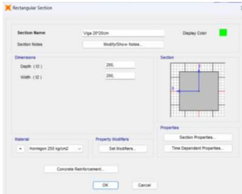
Figura 3-3 Vigas de 20\*20 empleadas en vigas banda. Fuente: (Autor - SAP, 2024)
