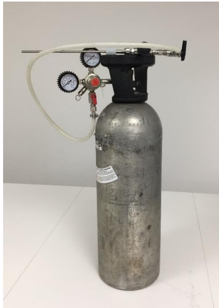
Imagen 12. Llenadora de botellas contrapresión
