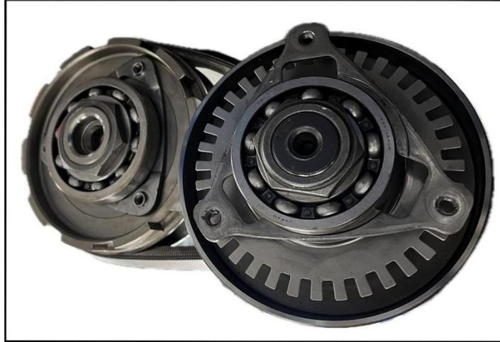
Se continuó con el proceso de despiece extrayendo el conjunto de la transmisión CVT, el cual estaba compuesto por poleas cónicas, una banda metálica y sus respectivos rodillos alojados en las salidas de los ejes. A continuación, en las figuras 26 y 27, se pudo encontrar el despiece del cuerpo de poleas y la banda.
