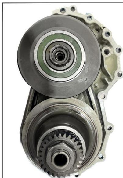
A continuación, en la figura 24 se aprecia la vista superior de las poleas y la banda metálica.
