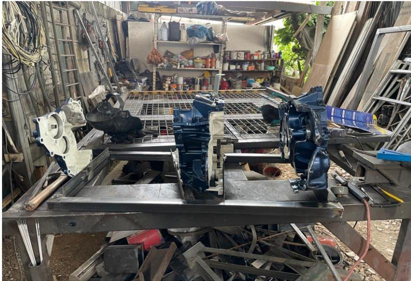
**Figura 37.** Montaje de la base del cuerpo de válvulas
