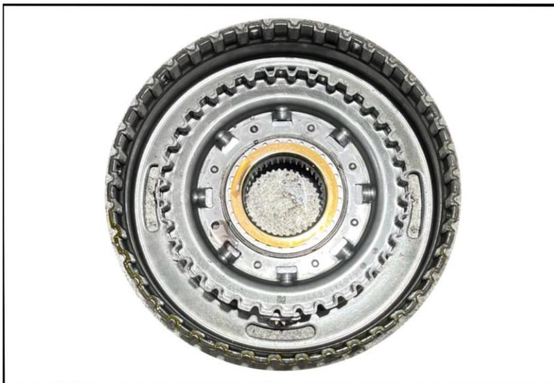
A continuación, en la figura 30 se aprecia los discos múltiples, junto a sus separadores:
