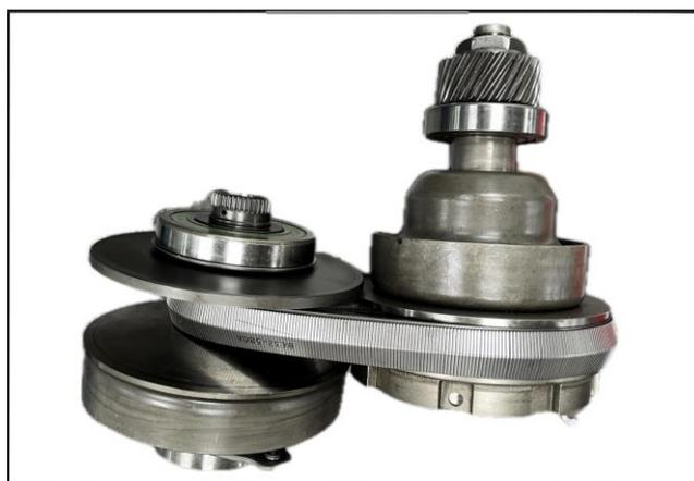
En la figura 25 se aprecia la parte posterior de las poleas cónicas:
