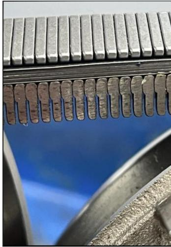
En la figura 18 se aprecia la cara izquierda de la banda y surcos en la banda.
