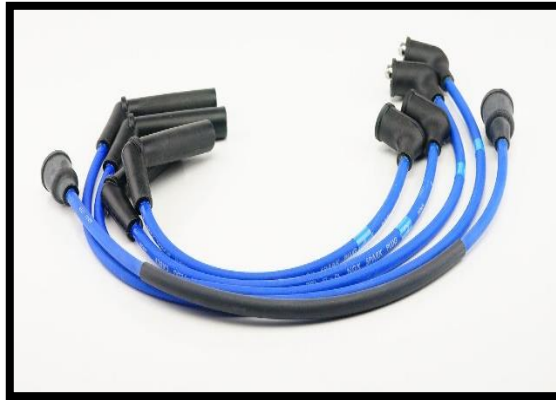
Figura 4. Cables de encendido
