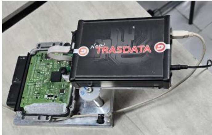
Figura 10. Equipo para la clonación de la ECU.
