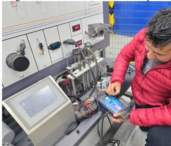
Figura 6. Conexión de escáner en la maqueta.
