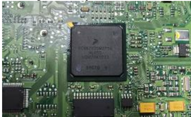
Figura 8. Microprocesador de la ECU.
