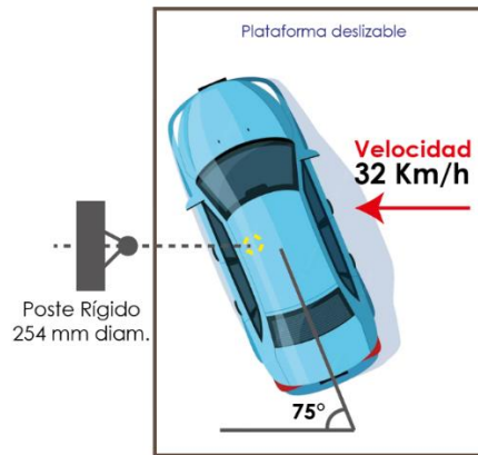
Fig. 6. Ensayo impacto lateral contra un poste según FMVSS 214.
