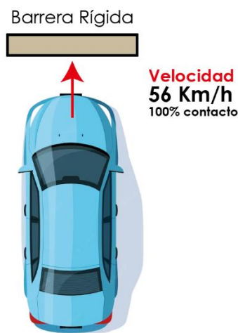
Fig. 5. Ensayo impacto frontal contra barrera rígida según FMVSS 208. Fuente: Autores.
