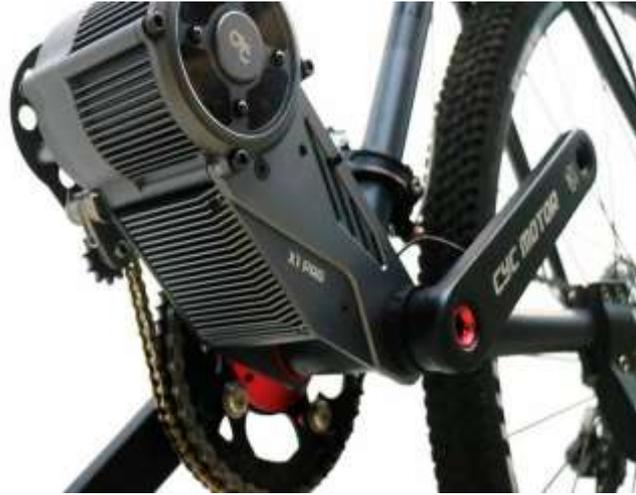
*Figura 7. Sistema de pedaleo asistido*
