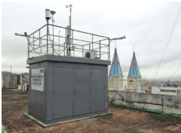
Figura 2. Estación automática de calidad del aire y meteorología localizada en la estación MUN [1].
