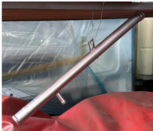
Figura 27. Tubo de agua nuevo
