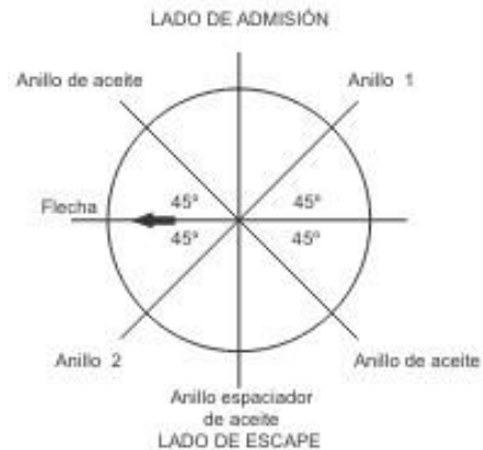
Figura 28. Posición de los anillos del pistón
