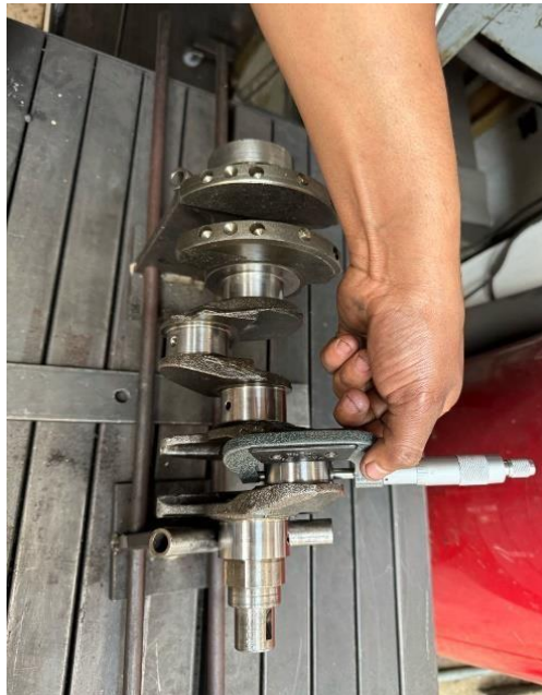
Figura 17. Mediciones del cigüeñal 1
