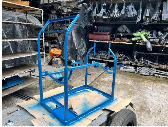
Figura 38. Pintura de estructura
