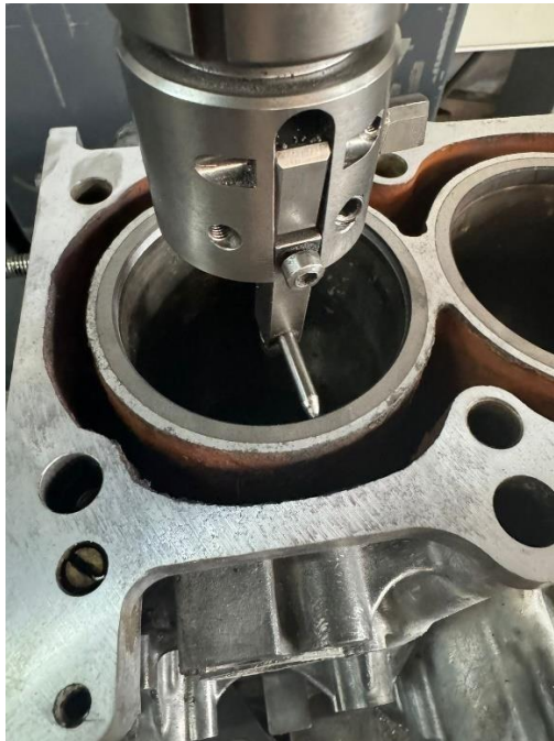
Figura 15. Comprobación de concavidad 2
