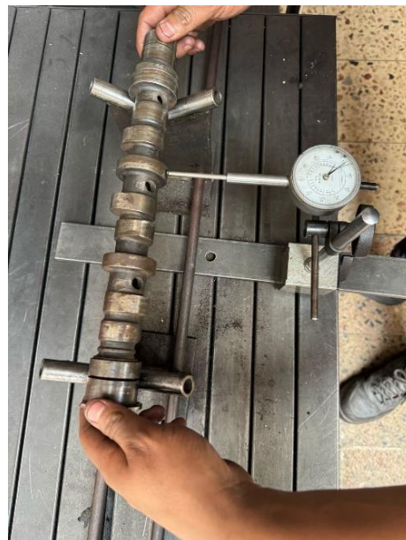
Figura 19. Comprobación del árbol de levas
