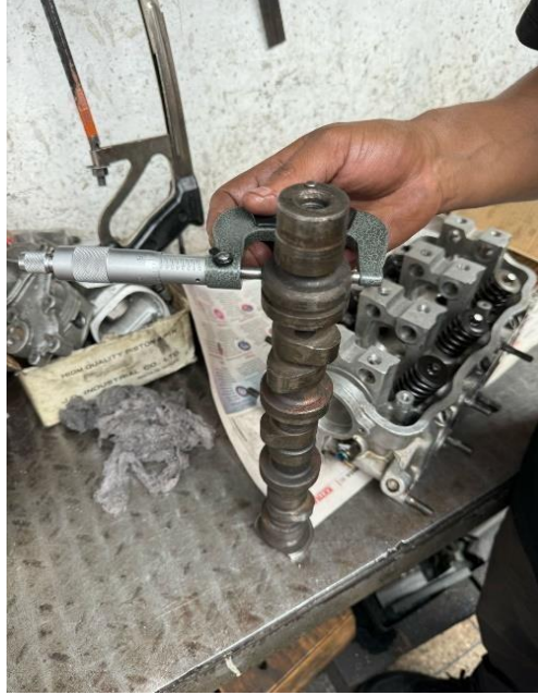
Figura 16. Medición de la leva
