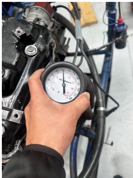
Figura 3. Compresión del motor
