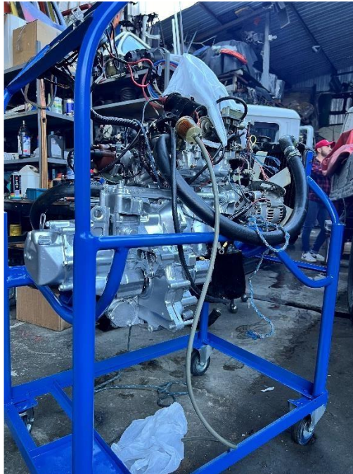
Figura 39. Montaje del motor en la estructura
