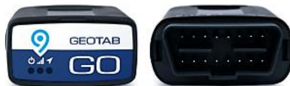
Figura 5. Dispositivo de telemetría Geotab GO9 utilizado para la investigación. Fuente: https://www.geotab.com/es/go9-support-document/
