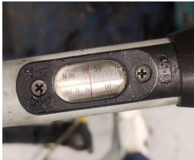
Imagen.9 (Torque de la bomba de aceite “27 Nm”)
