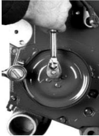
Figura.8 (Extracción polea bomba de agua)
