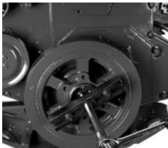
Figura.7 (Retiro de la polea del cigüeñal)
