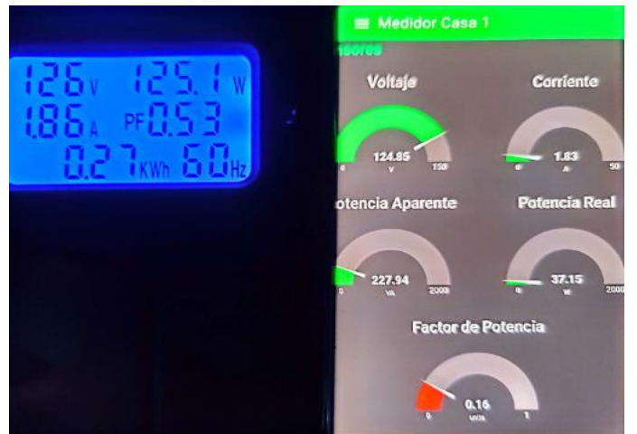
Fig. 6. Valores medidos en vatímetro y dispositivo en carga capacitiva (refrigeradora).
