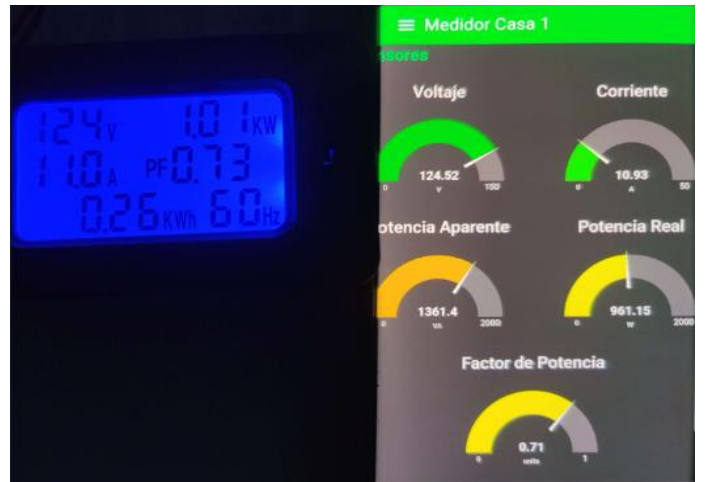
Fig. 5. Valores medidos en vatímetro y dispositivo en carga capacitiva (televisión).
