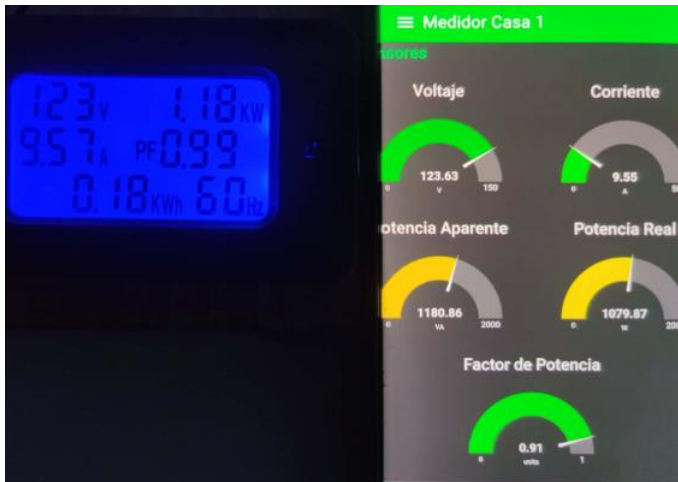
Fig. 2. Valores medidos en vatímetro y dispositivo en carga resistiva (plancha).
