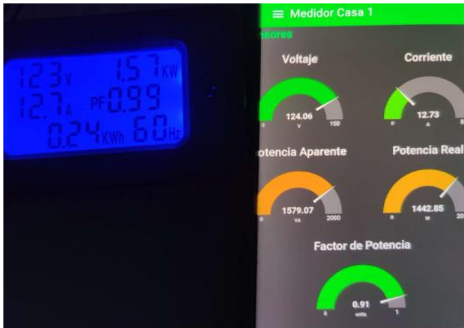
Fig. 3. Valores medidos en vatímetro y dispositivo en carga inductiva (licuadora).
