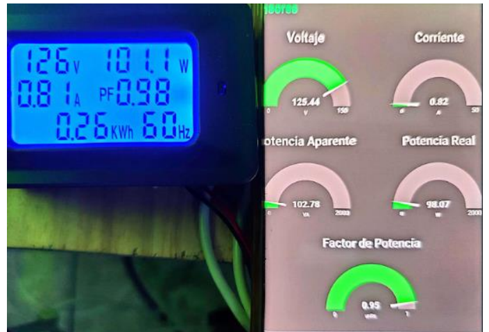
Fig. 6. Valores medidos en vatímetro y dispositivo en carga capacitiva (refrigeradora).
