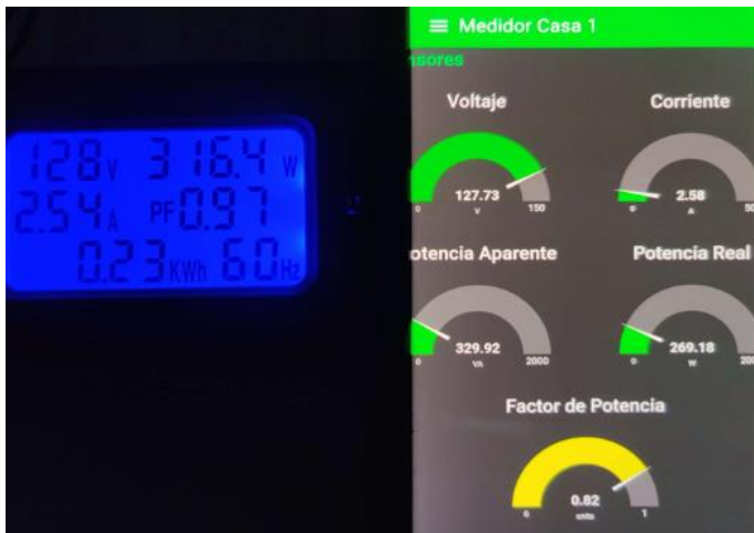
Fig. 3. Valores medidos en vatímetro y dispositivo en carga inductiva (licuadora).
