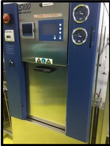
Por su función específica, se ha clasificado como un equipo de equipo de **bajo nivel invasivo, bajo riesgo**. Utilizado para esterilizar instrumentos del laboratorio y del quirófano.
