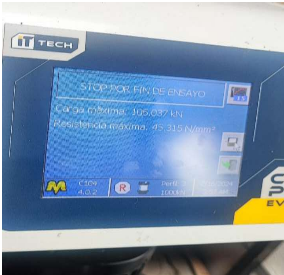
Figura 6. Resultado de prueba de compresión uniaxial
