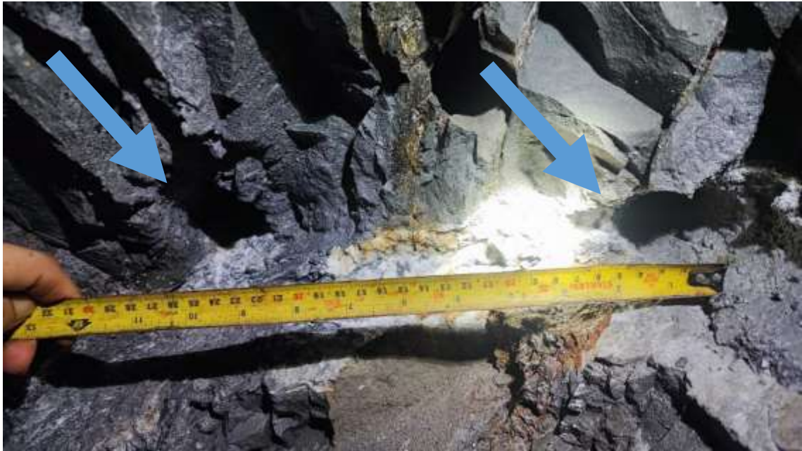
Figura 9. Espaciamiento entre perforación.
