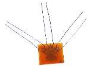
Fig 4. Galga extensiométrica 120WR, roseta triaxial
