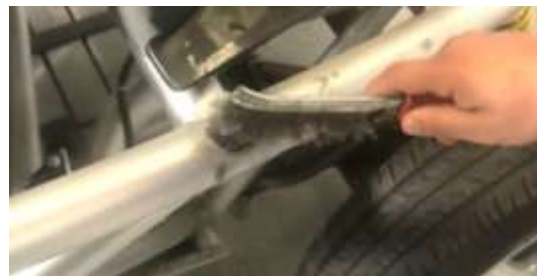
Fig 5. Limpieza en el tubo superior, ubicación de la galga 1
