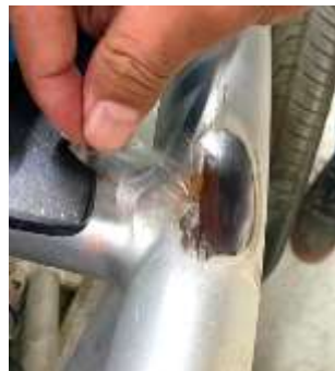
Fig 8.b. Ubicación de la galga en el chasis
