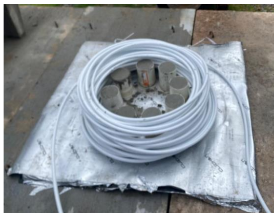
Figura 7. Manguera enroscada en los cilindros
