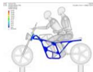
Figura 2. - Análisis CAE de esfuerzo y deformación del chasis de la motocicleta por cargas dinámicas. [1]
