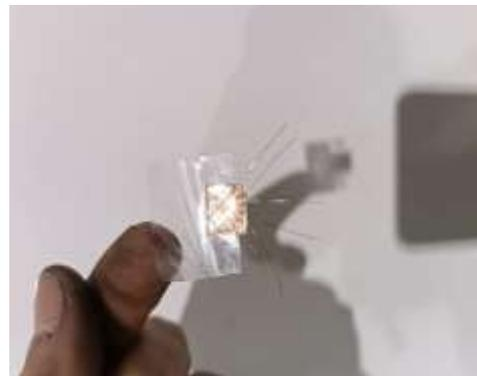
Figura 10.- Preparación de la galga extensiométrica.
