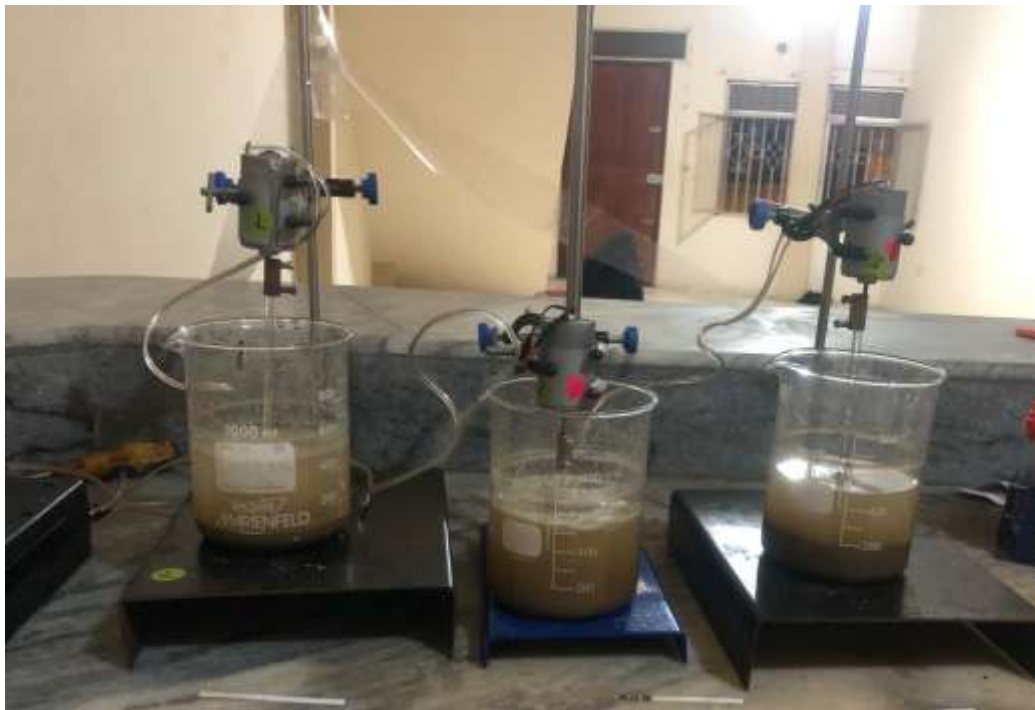
Figura 2. Ejecución de pruebas de cianuración
