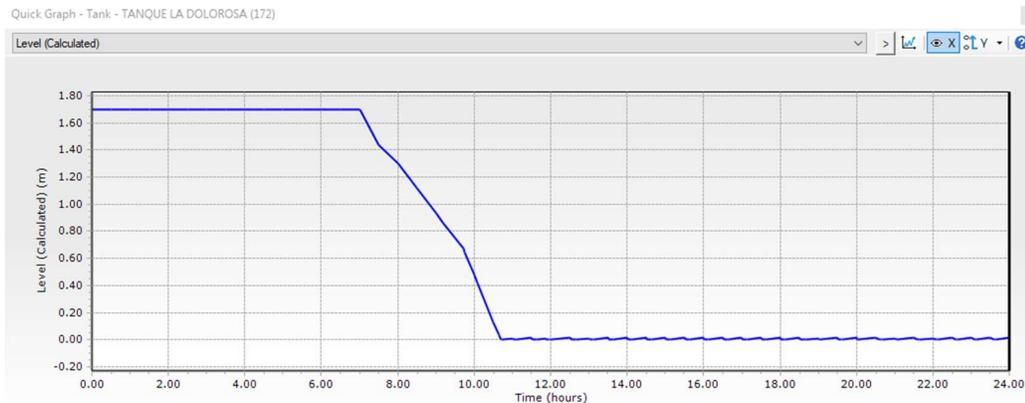
**Figura 49. Curva de descarga de la reserva la Dolorosa descargando tanqueros de la empresa ETAPA EP. - Fuente: Autor**
