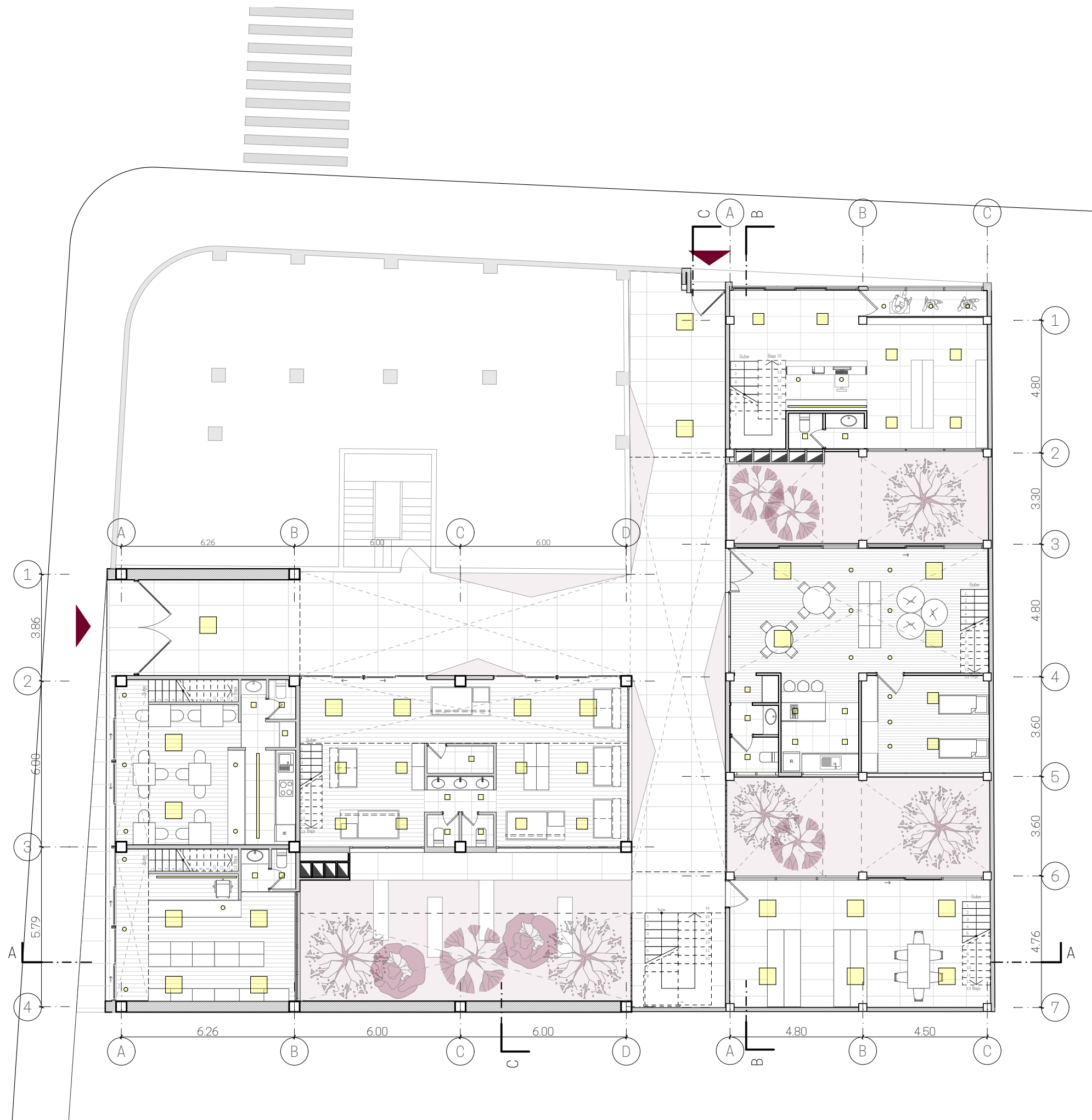
Planta de iluminación de planta baja ESCALA 1: 150
