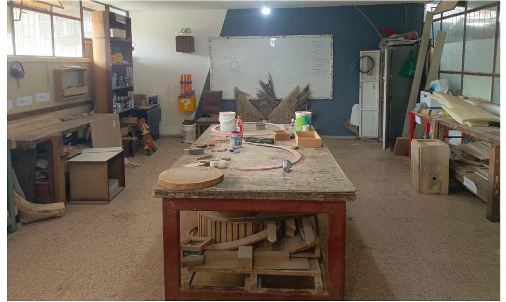
Fig. 46. Taller de ebanistería con espacios reducidos y sin ventilación adecuada.
