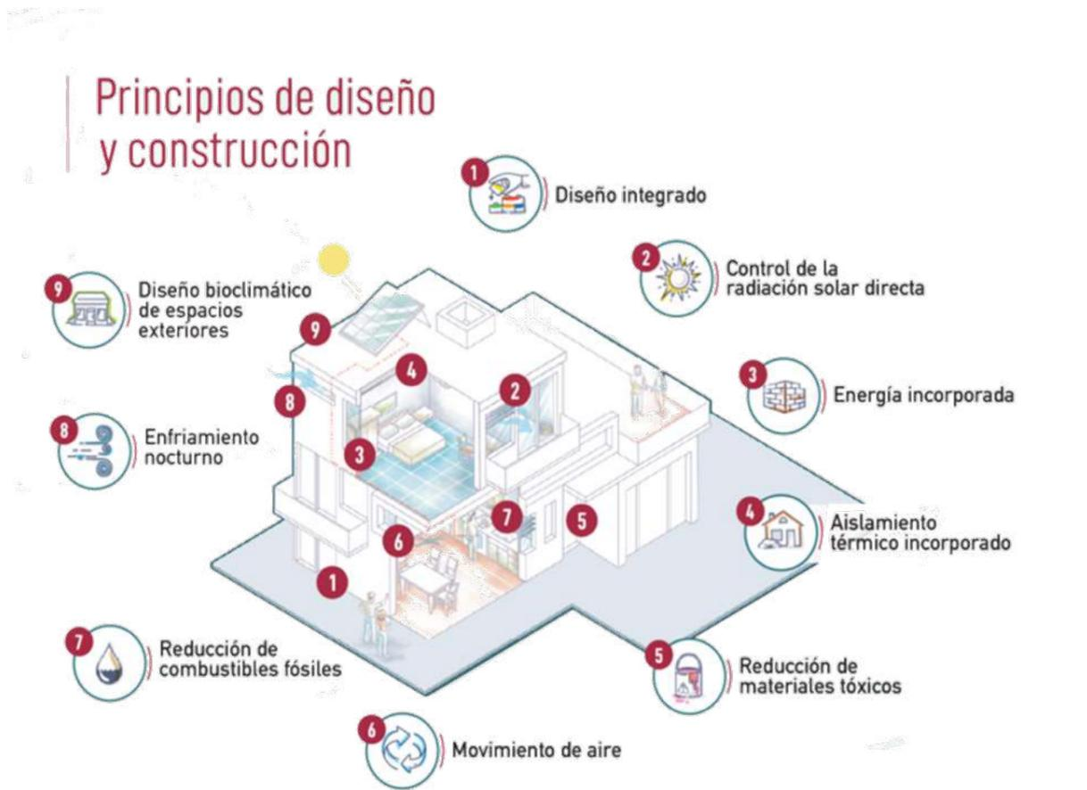
Img.05 Principios de diseño y construcción Fuente. Ceela
