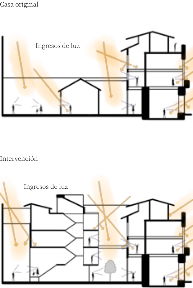
Figura 12: Visuales e ingreso de luz solar del proyecto antes y después de la intervención Fuente: Catálogo BAQ (2020), Elaboración propia
