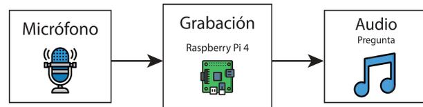
Fig. 4. Diagrama del funcionamiento de la etapa de Grabación.
