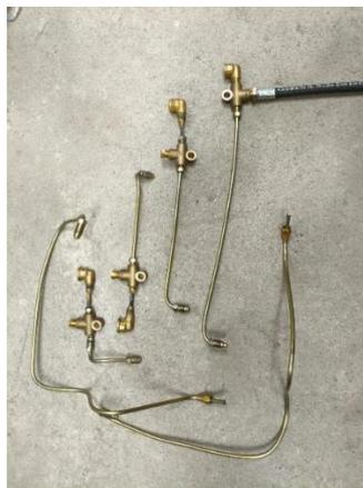
Además, incorporamos válvulas de purga en el circuito. Estas válvulas tienen un papel muy importante: permiten eliminar el aire que pueda haber quedado atrapado dentro de las tuberías. Esto es esencial porque la presencia de aire puede alterar las mediciones de presión, haciendo que los resultados no sean precisos.
