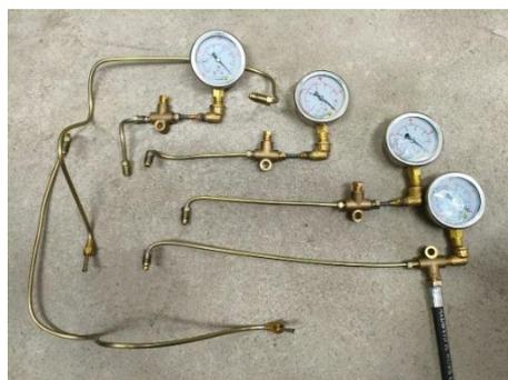
Al asegurar que el circuito esté completamente lleno de líquido y libre de aire, logramos que los manómetros muestren valores reales y confiables, lo cual es clave para demostrar el buen funcionamiento del sistema y que la maqueta cumpla su objetivo educativo de manera efectiva.
