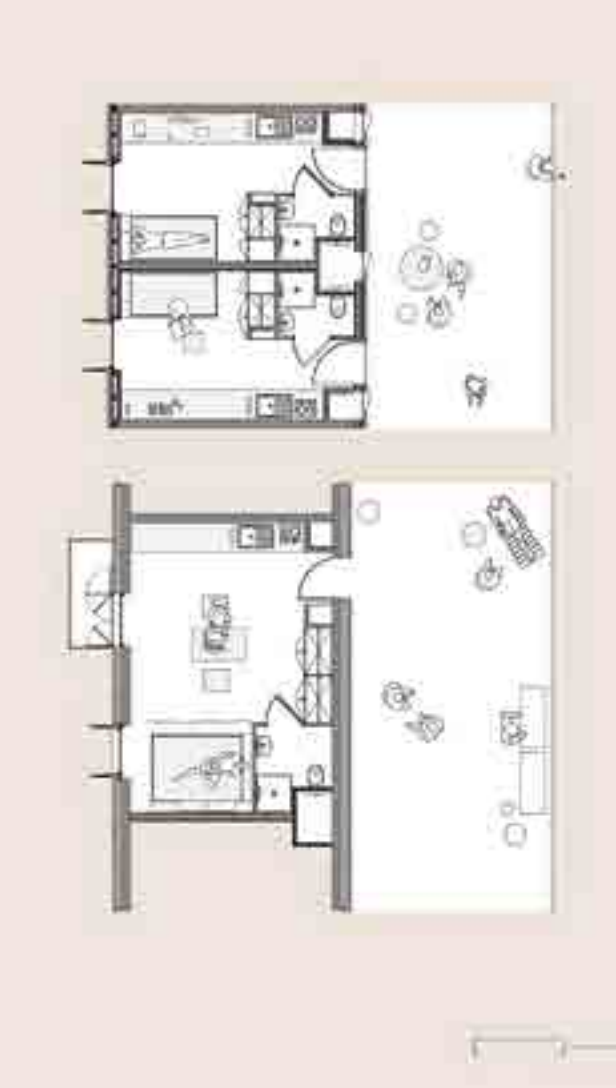
Fig 10: Plano de Habitaciones con terrazas comunes de la residencia Universitaria Olympe de Gouges por PPa architectures
