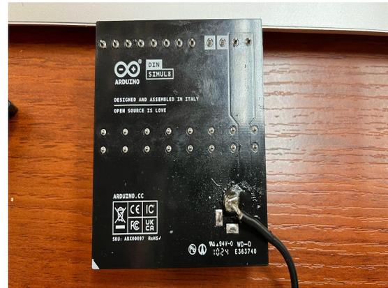
Fig. 6: Soldado de la placa arduino simul8.
