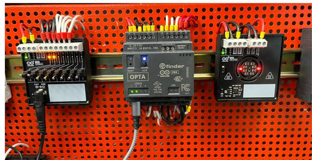
Fig. 17: Control y monitoreo de temperatura con Arduino Din Celsius.
