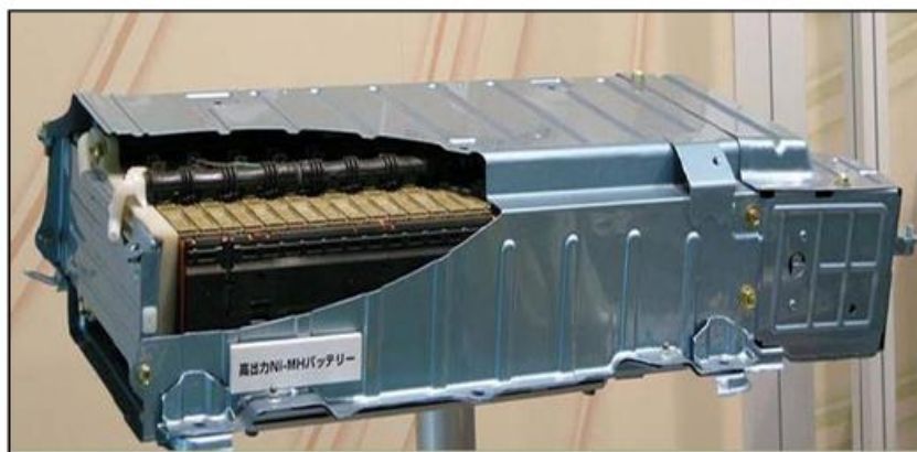
Figura 33: Batería de níquel-MH
