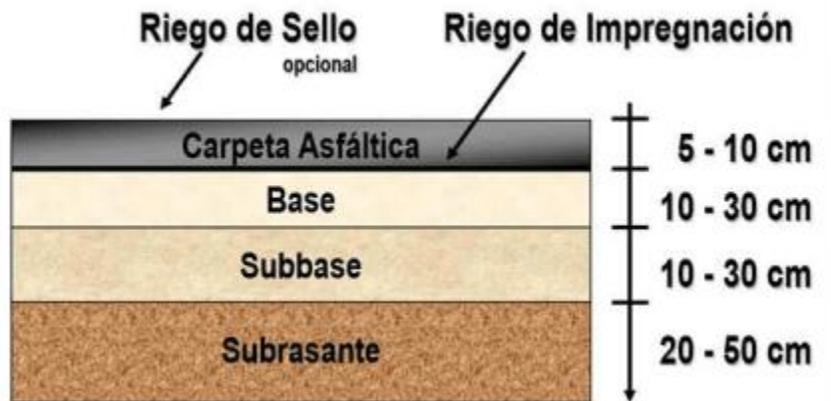
Nota. La figura representa la estructura que conforma un pavimento e indica el espesor que debe llevar el mismo. Fuente: ¿Que es un pavimento flexible?, por Farro, A 2024.
