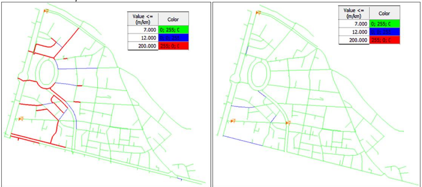
Ilustración 3.11 Comparación pérdidas de carga antes y después de la optimización
