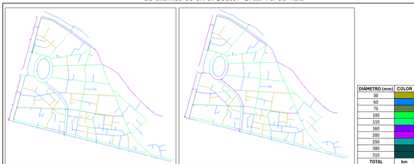
Ilustración 3.1 Comparación de diámetros antes y después de la optimización de diámetros en el Sector Cruz Verde 4B2
