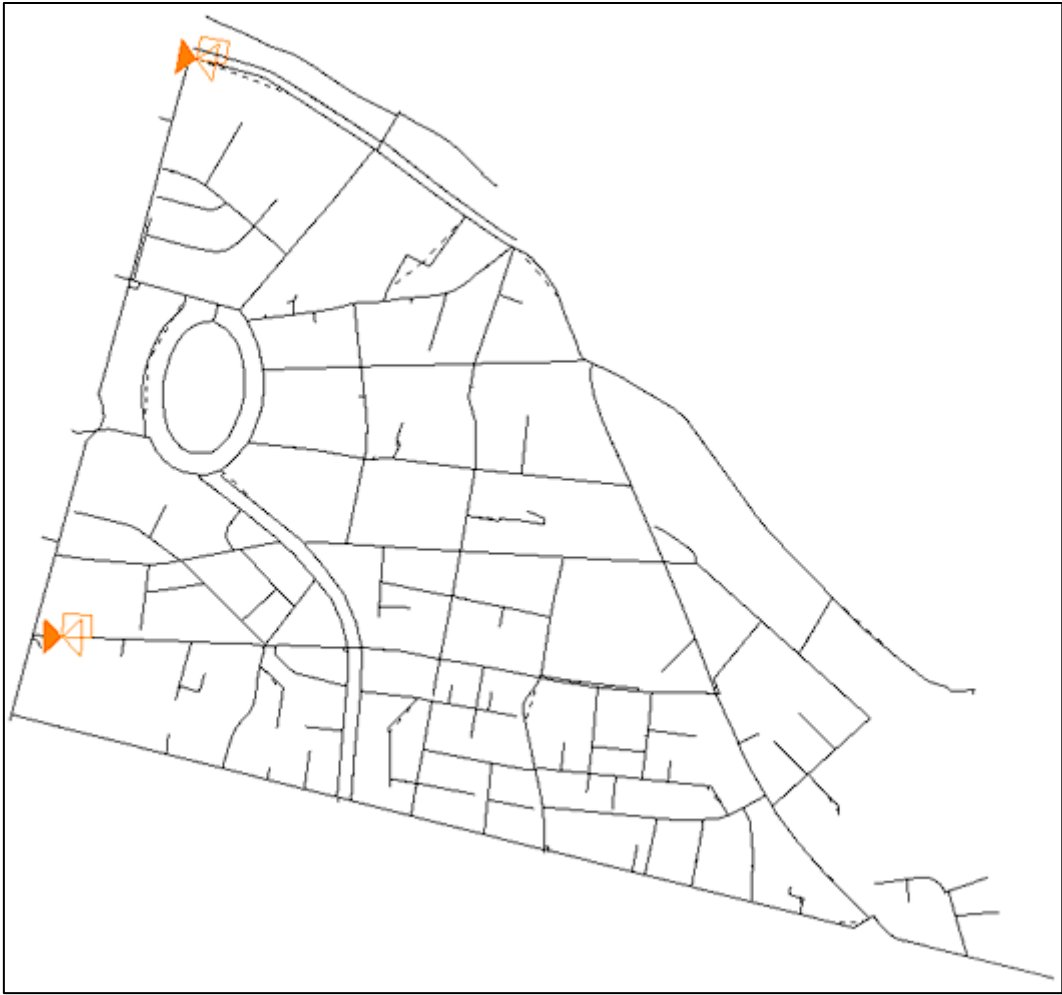
Anexo 5. Ubicación de PRVs en zona de estudio del sector Cruz Verde 4B2 Norte, modelo hidráulico 2050 sin optimizar
