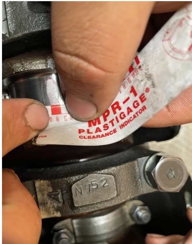
Imagen 15: Verificación película de aceite en biela.
