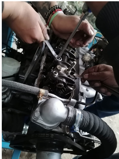
Figura 24: Calibración de válvulas
