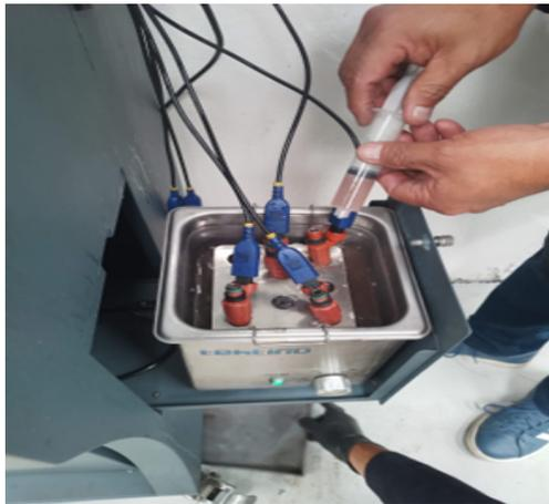
Figura 19. Cambio de los retenes de los inyectores.
