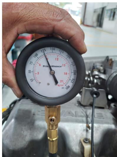
Figura 22. Verificación de fugas en el cilindro número cuatro cada cilindro.
