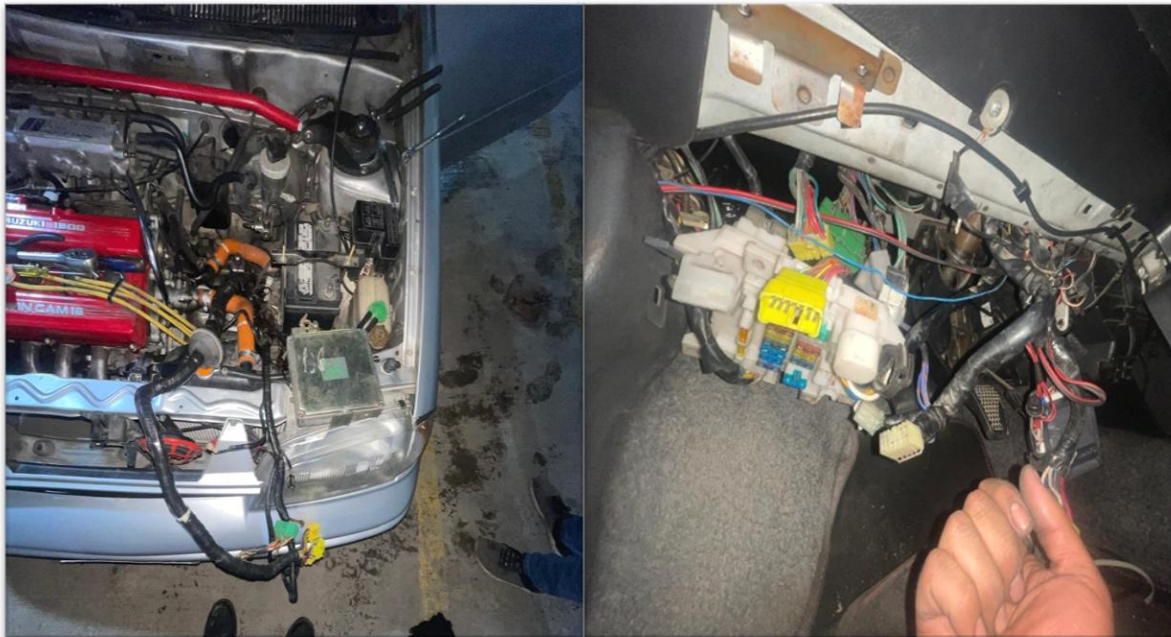
Figura 3 Extracción del cableado antiguo
