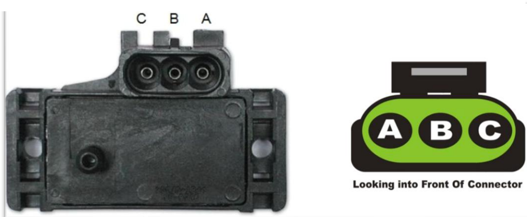
Figura 7 Sensor MAP conexión (Manual Haltech)
