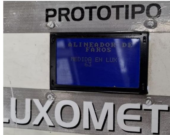
Figura 21. Respuesta del LDR a la luz
